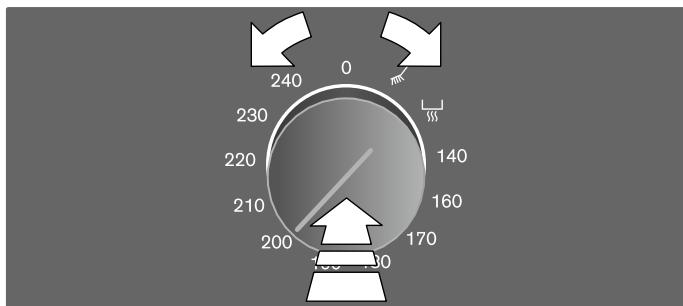
Kolor podświetlanego pierścienia zmienia się z białego na pomarańczowy, dopóki urządzenie nagrzewa się. Po osiągnięciu ustawionej temperatury rozlega się dźwięk sygnału.
