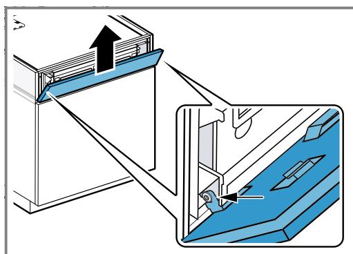
10. Перевірте розташування передньої пластини на фронтальній панелі.
