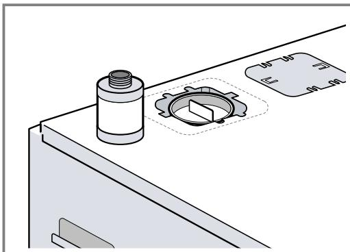
2. Снимите транспортировочное крепление насоса на верхней стороне прибора.
