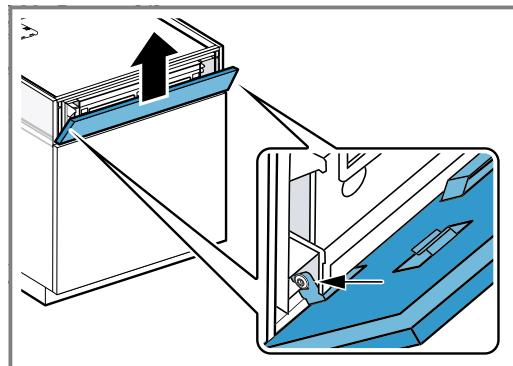
10. Проверьте положение передней панели на фасаде.
