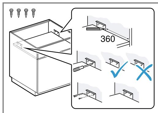
2. Прикрутите монтажные уголки к мебели с помощью приспособления для крепежа.
