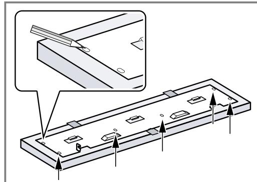
12. Снимите переднюю панель с мебельного фасада и удалите двустороннюю клейкую ленту.
