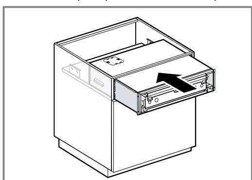
3. Если прибор не удается установить, отрегулируйте уголок для защиты от опрокидывания по высоте. Для этого ослабьте винты и сдвиньте уголок для защиты от опрокидывания вверх.
