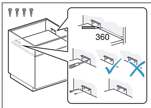
2. Закріпіть монтажний кронштейн допоміжним монтажним засобом на меблях.
