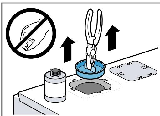
3. Закрепите транспортировочное крепление на задней панели прибора для последующего использования.
